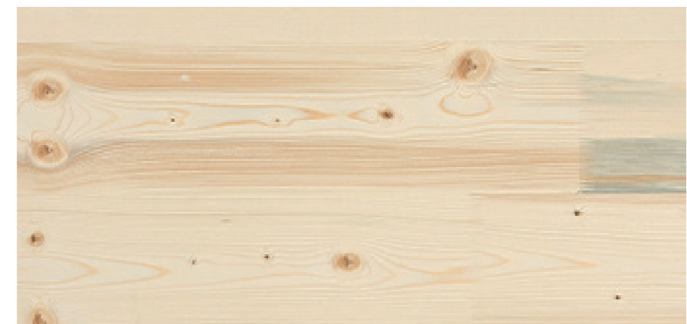
Industriequalität (I) Rein konstruktive Massivholzplatten zur Beplankung mit anderen Materialien (Klasse 1)
