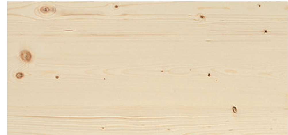
Sichtqualität (S) Massivholzplatte für den sichtbaren Wohnbereich geeignet (Klasse 3)
